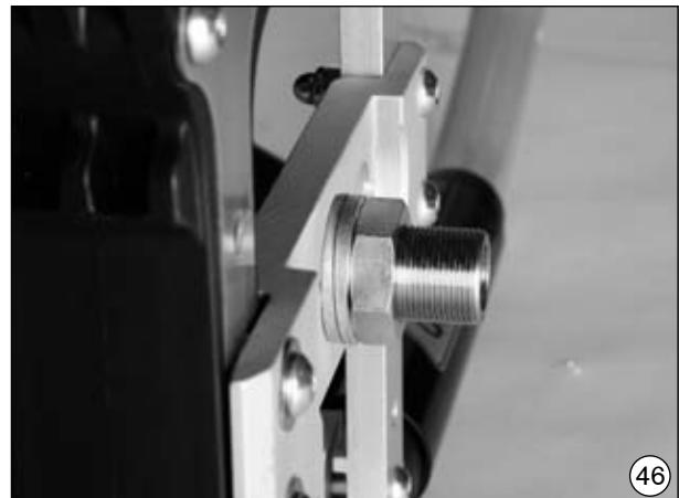
**Réglage du déport des roues motrices à 2,5°:** placez le disque de carrossage dans la position d'arrêt souhaitée avec son côté le plus mince tourné vers le haut (ill. 47) sur la face externe de l'adaptateur des roues motrices. Placez le second disque de carrossage dans la position d'arrêt souhaitée avec son côté le plus épais tourné vers le haut sur la face interne de l'adaptateur des roues motrices.
