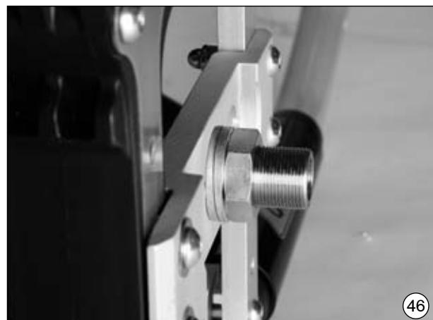
**Wielvlucht van de aandrijfwielen instellen op 2,5°:** Positioneer de wigring met de smalle kant omhoog in de gewenste vergrendelingsstand (afb. 47) aan de buitenkant van de aandrijfwielaar. Positioneer de tweede wigring met de brede kant omhoog aan de binnenkant van de aandrijfwielaar in de overeenkomstige vergrendelingsstand.
